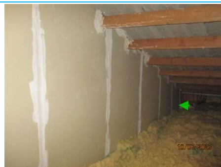
Matériaux : ZPSO-003 Prélèvement : P003 Description : Relevé : revêtement bitumineux Localisation : COMBLES - COMBLES 1 Résultat : Absence d'amiante
