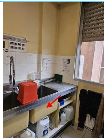
Matériaux : ZPSO-109 Prélèvement : P106 Description : enduit sous évier Localisation : Niveau 1 - S121 Résultat : Présence d'amiante
