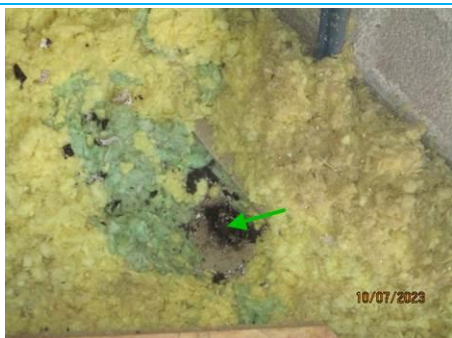
Matériaux : ZPSO-006 Prélèvement : P006 Description : Partie plane : revêtement bitumineux Localisation : COMBLES - COMBLES 1 Résultat : Absence d'amiante
