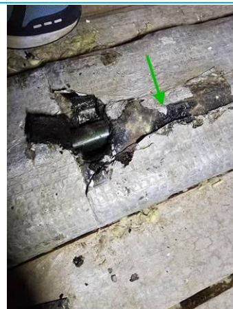
Matériaux : ZPSO-150 Prélèvement : P146 Description : Couvre-joints Localisation : COMBLES - COMBLES 1 Résultat : Absence d'amiante
