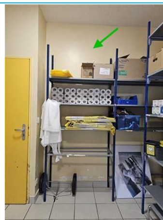
Matériaux : ZPSO-107 Prélèvement : P104 Description : Enduit cloison Localisation : Niveau 1 - S121 Résultat : Absence d'amiante
