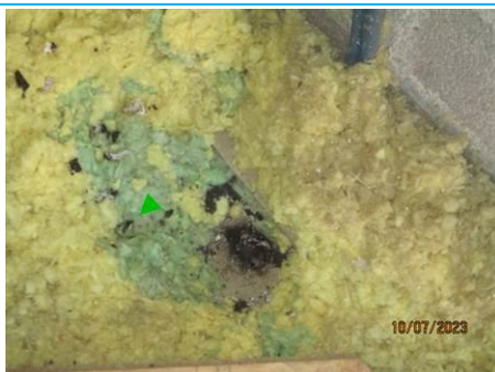
Matériaux : ZPSO-002 Prélèvement : P002 Description : Isolant fibreux VERT Localisation : COMBLES - COMBLES 1 Résultat : Absence d'amiante
