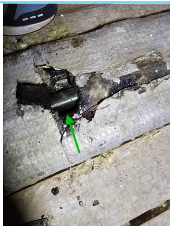
Matériaux : ZPSO-151 Prélèvement : P147 Description : Couvre-joints Localisation : COMBLES - COMBLES 1 Résultat : Absence d'amiante
