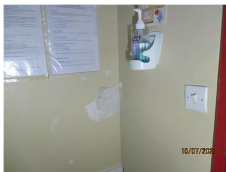
Matériaux : ZPSO-071 Prélèvement : P071 Description : Enduit MUR ORANGE Localisation : NIVEAU 2 - M233 Résultat : Absence d'amiante
