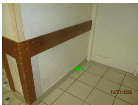
Matériaux : ZPSO-030 Prélèvement : P030 Description : Colle de PLINTHE Localisation : NIVEAU 2 - K299; NIVEAU 2 - HALL M247; NIVEAU 2 - M248; NIVEAU 2 - K298; NIVEAU 2 - M205 Résultat : Absence d'amiante
