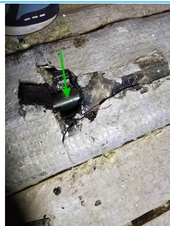
Matériaux : ZPSO-152 Prélèvement : P148 Description : Joint de dilatation Localisation : COMBLES - COMBLES 1 Résultat : Absence d'amiante
